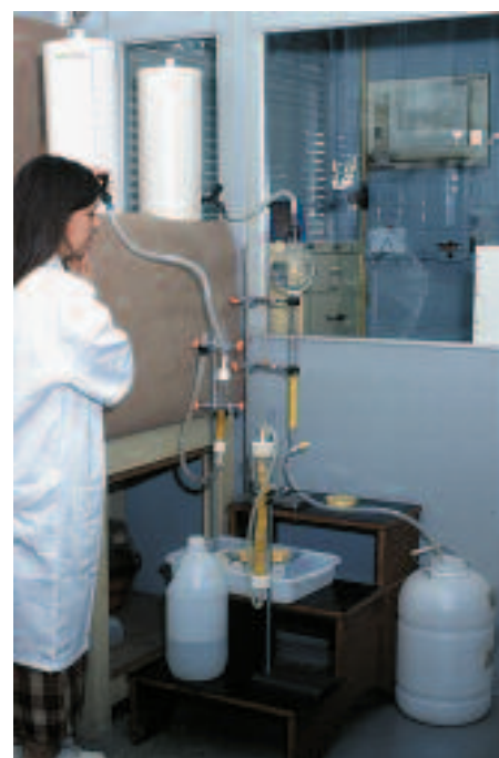
Extração líquido-líquido (acima) e técnica de recuperação de metais (abaixo): tratamento de rejeitos pode gerar patentes.
