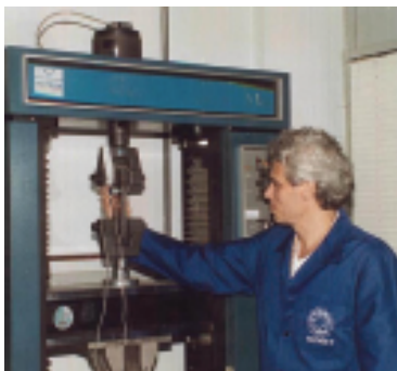
Tiras de prova dos dutos serão submetidas a diversas cargas.
