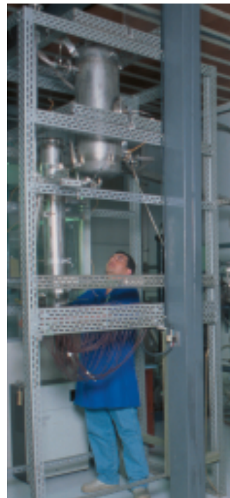
Circuito-piloto do IEN tem 1/10 da altura do modelo real.
